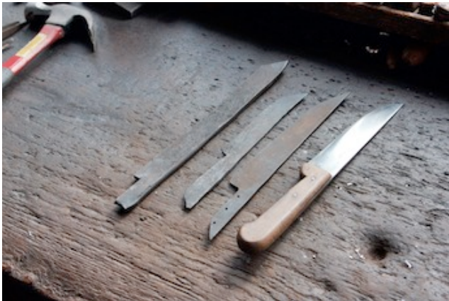
Die vier Stufen traditionellen Messerbaus: Stahlstück, geschmiedete Form, grob geschliffenes Stück mit Heftlöchern, messerscharfes Resultat.
