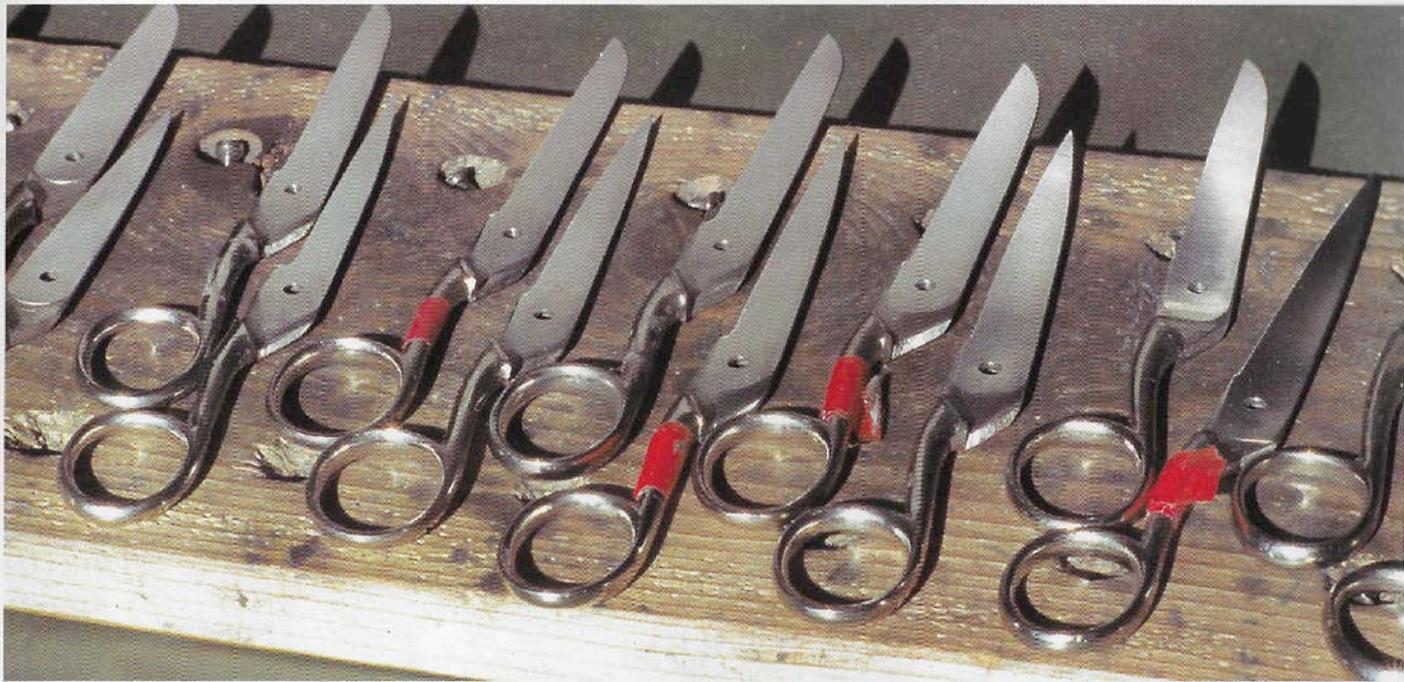
*Eine Serie von Scheren wird zum Schleifen bereitgestellt*
